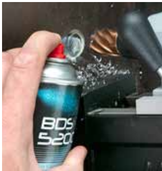
Paso 2: Durante el taladrado, aplicar spray de alto rendimiento en la punta de la broca y en el taladro.
