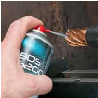
Paso 1: Antes de iniciar los trabajos de taladrado, aplicar directamente spray en las brocas.
