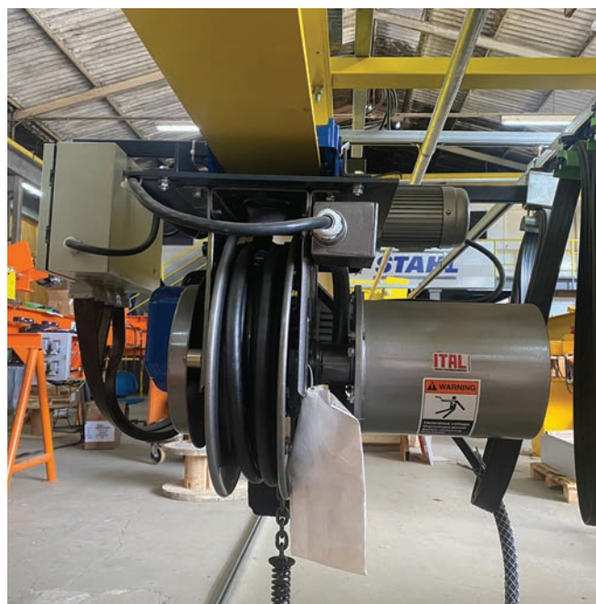
Figura 17: as duas figuras de cima mostram uma aplicação aonde se utiliza o enrolador para recolhimento do cabo. Já as duas figuras de baixo mostram uma aplicação sem o enrolador: quando o eletroímã sobe o cabo não o acompanha e forma uma “perigosa” barriga.
