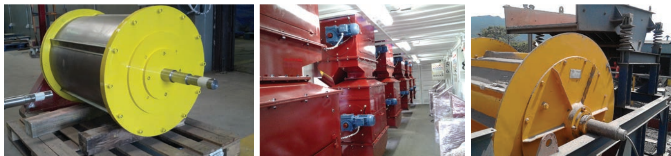
Figura 32: Sugestões de instalação de tambores magnéticos.
