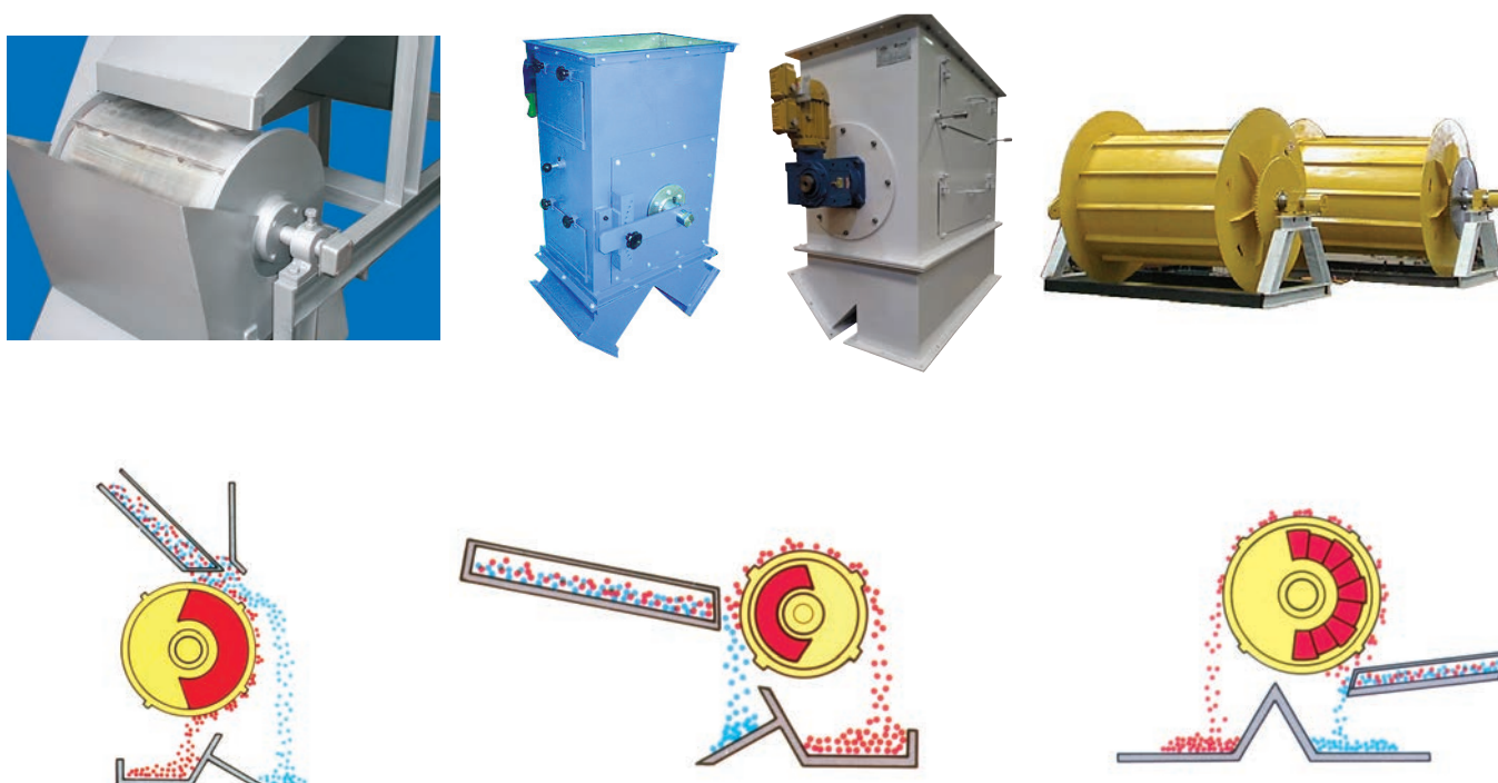
Figura 32: Sugestões de instalação de tambores magnéticos.
